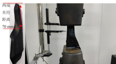
图5 断裂应力测量
