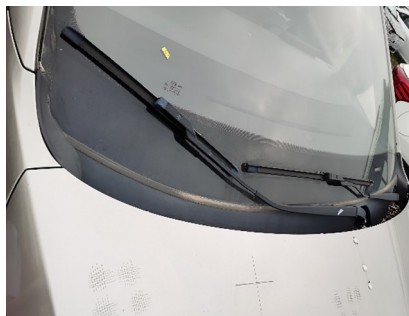
图14 综合耐久试验车的雨刮侧盖板
