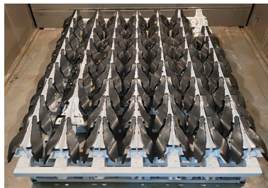
图2 模拟装配工装台架
